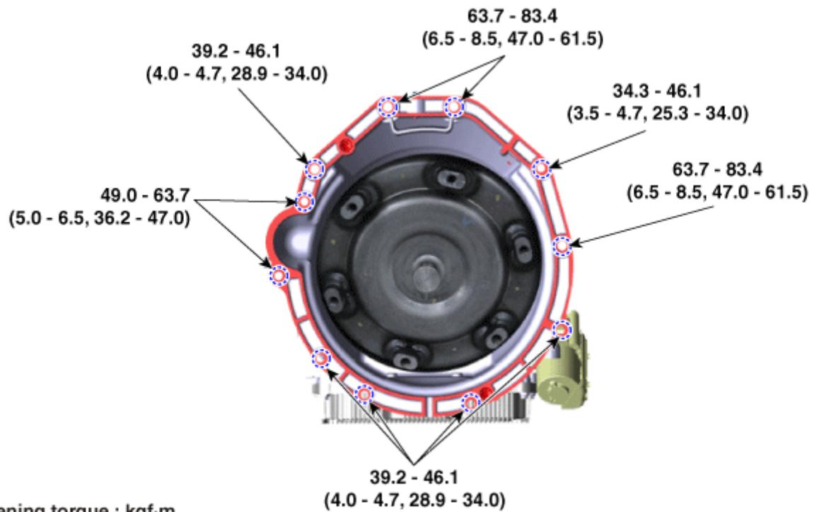
Tightening torque : kgf·m
